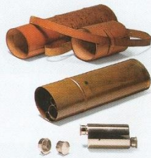
Hypsometer, um 1850, hergestellt in Deutschland. Über den Siedepunkt des Wassers ließ sich zunächst der Luftdruck und somit auch die Höhe eines Ortes bestimmen.
