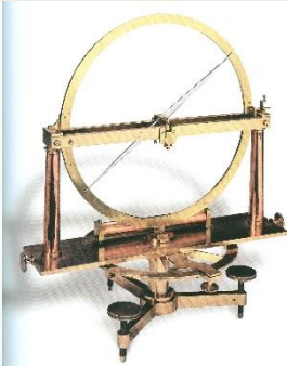
Sextante portátil, Paris, 1749. El instrumento fue diseñado por A. Huygens para medir la altura del sol. Museo Naval, Madrid.
