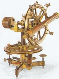
Humboldts zwölfzölliger Universalthedolit, hergestellt von Gambey, Paris. Er diente während der russischen Reise zu geodätischen Messungen.
