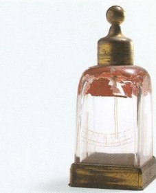
Strohalm-Elektrometer, um 1790, hergestellt in Deutschland. Die Auslenkung des Strohhalmes zeigt elektrische Potentialunterschiede an.
